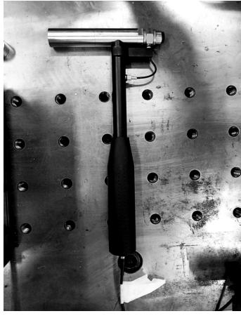
(a) Brüel & Kjær type 8202 impact hammer.
